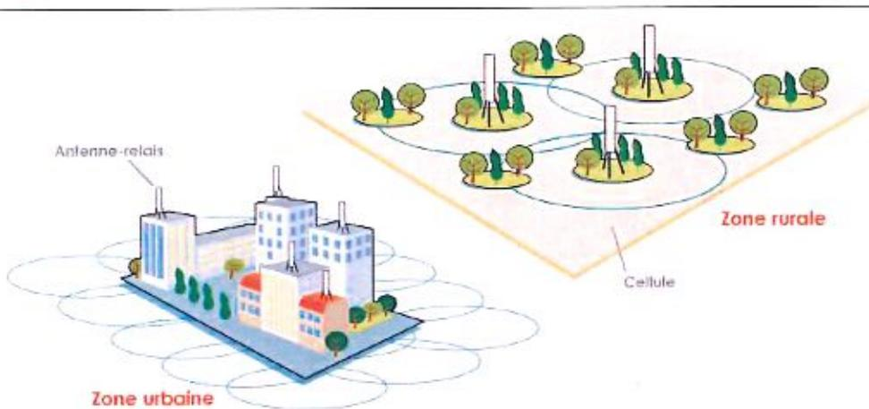
L'antenne-relais émet des ondes dans une direction privilégiée. Ce faisceau peut être comparé à celui d'un phare qui éclaire la mer. Les faisceaux principaux de l'antenne sont directifs et très fins (6 degrés environ) dans le plan vertical. L'intensité du faisceau diminue très rapidement (en fonction du carré de la distance) en s'éloignant de l'émetteur. Cf. schéma ci-dessous à titre indicatif.
